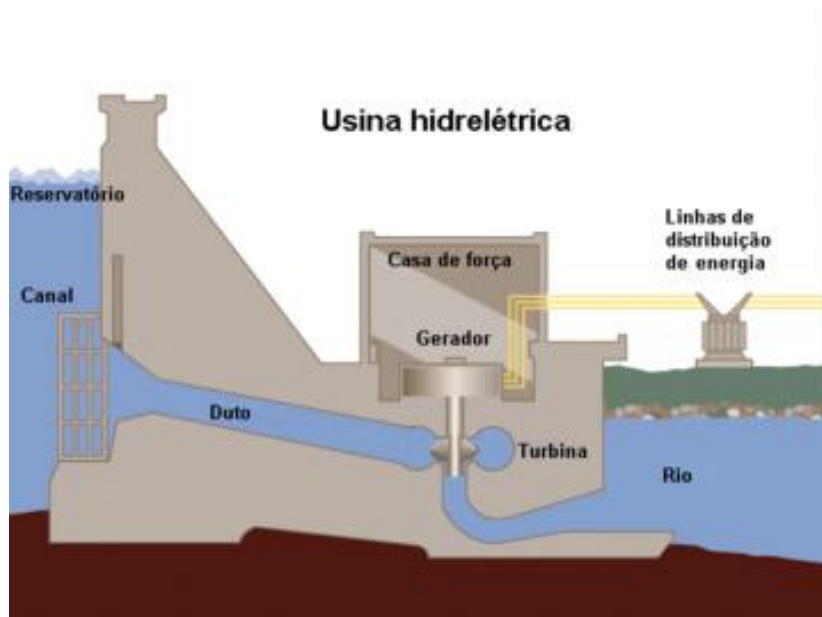
Imagem de uma usina hidrelétrica com as etapas de geração de energia 6
