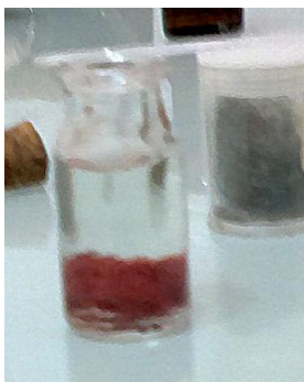
Figura 4 – Resultado final da atividade 1. Durante a transformação química, ocorre a formação de um depósito castanho-avermelhado sobre a superfície da palha de aço e a solução perde a sua coloração azulada. Com o passar do tempo, a palha de aço se dissolverá, restando apenas o depósito formado. Agora, Responda as seguintes questões com base no experimento realizado:
